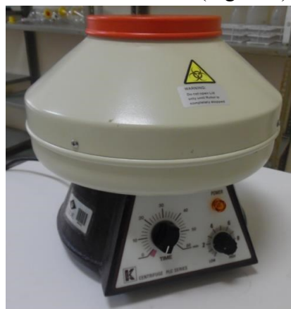
Figura 3. Cámara de Neubauer para conteo de algas y Centrífuga para acelerar procesos de sedimentación y facilitar la toma de muestras por resuspensión.
