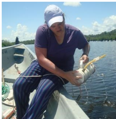
Figura 2. Recolección de muestras de fitoplancton con botella Van Dorn y medición de oxígeno y temperatura con equipo multiparámetros.
