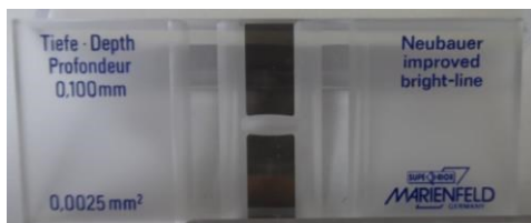
Figura 3. Cámara de Neubauer para conteo de algas y Centrífuga para acelerar procesos de sedimentación y facilitar la toma de muestras por resuspensión.
